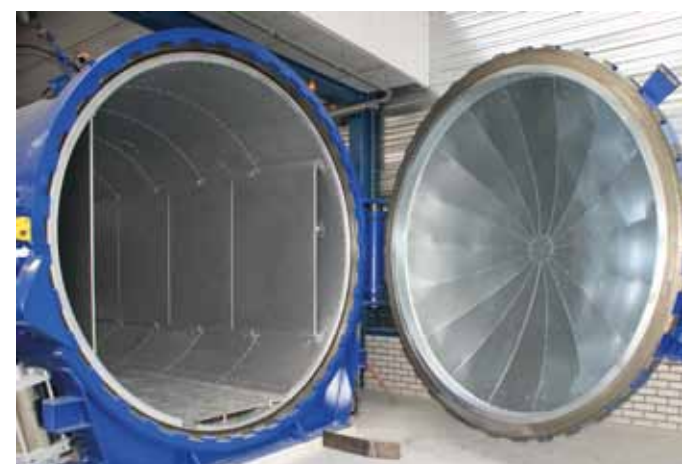
In de autoclaaf wordt onder hoge druk de lucht tussen de folie en het glas verwijderd (foto GSWB)
