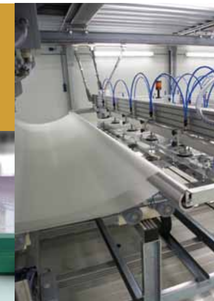
Verwerking van de folie in het gelaagde glas (foto GSWB)
